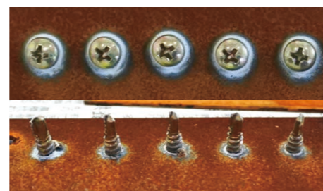
SUS410 他社高耐食不動態皮膜処理
