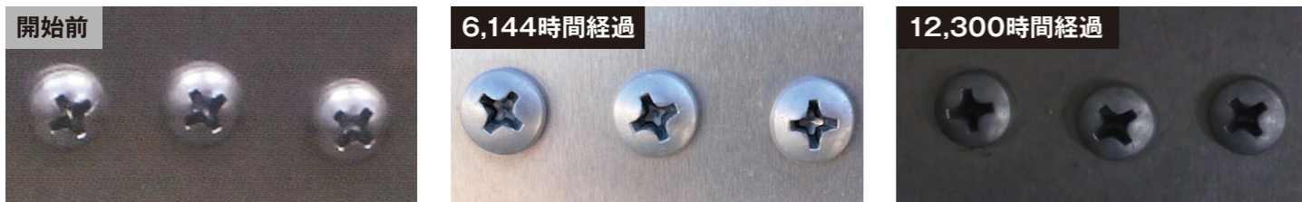
電食は発生していない
