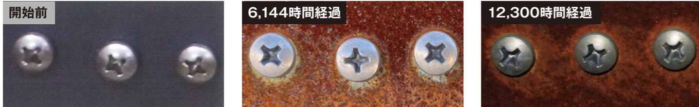
犠牲防食が働き、鉄板の赤錆発生も抑えている
